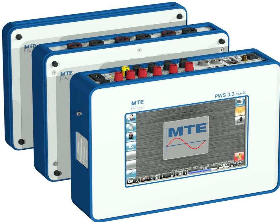
Der PWS 3.3 genX ist eine Kombination von einem dreiphasigen Arbeitsnormal der Klasse 0.05 % und einem IEC 61000-4-30 Klasse A kompatiblen Netzqualitätsanalysator mit 4 Spannungskanälen (U1, U2, U3, UN, UPE) und 4 Stromkanälen (direkt: I1, I2, I3 und via Stromzange: IN / IPE Nulleiter- / Schutzleiterstrom).
